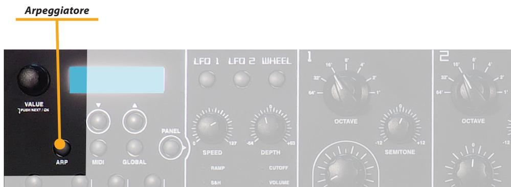
Questa funzione è generatore automatico di arpeggio, sotto il controllo di poche, chiare e semplici pagine di menu programmabili dell'utente, che si possono scorrere con i tasti dedicati sotto il display, mentre il controllo desiderato e / o il parametro viene selezionato tramite l'encoder *Value*.
